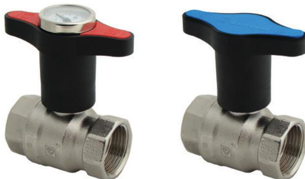
ШАРОВОЙ КРАН ГЕРЦ МОДЕЛЬ 2206, размеры DN 15 (1/2") до DN 50 (2"), номинальное давление 25 бар, вода, рекомендуются для сантехнических систем. Рукоятка рычажная или в форме крыла (бабочка). Подключение с двух сторон внутренней резьбой согласно ISO 7. Корпус из специальной латуни устойчивой к вымыванию цинка, без покрытия. Рукоятка красная. Кошух теплоизоляционный 4096 из EPP (вспененный полипропилен), цвет антрацитово-чёрный или серебристо-серый.
