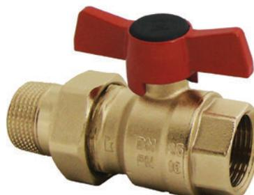
ШАРОВОЙ КРАН ГЕРЦ МОДЕЛЬ **2206**, размеры DN 15 (1/2") до DN 50 (2"), номинальное давление PN 25 бар, вода, рекомендуются для сантехнических систем. Рукоятка воротковой формы. Подключение с двух сторон внутренней резьбой согласно ISO 7. Корпус из специальной латуни устойчивой к вымыванию цинка, без покрытия. Рукоятка черного цвета с красной или синей накладкой для модели с термометром. Кошух теплоизоляционный **4096** из EPP, цвет антрацитово-чёрный или серебристо-серый.
