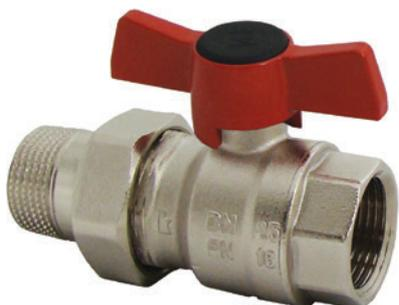
ШАРОВОЙ КРАН ГЕРЦ МОДЕЛЬ 2201, размеры DN 15 (1/2") до DN 50 (2"), номинальное давление 25 бар, вода, масло, рекомендуются для систем отопления. Рукоятка воротковой формы. Подключение с двух сторон внутренней резьбой согласно ISO 7. Латунный корпус никелирован, рукоятка черного цвета с синей или красной накладкой для модели с термометром. Кошух теплоизоляционный 4096 из EPP (вспененный полипропилен), цвет антрацитово-чёрный или серебристо-серый.
