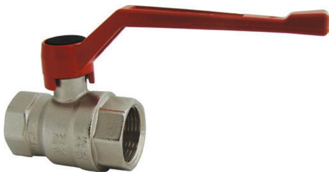
ШАРОВОЙ КРАН ГЕРЦ МОДЕЛЬ 2211, размеры DN 15 (1/2") до DN 50 (2"), номинальное давление 25 бар, вода, масло, рекомендуются для систем отопления. Рукоятка рычажная или в форме крыла (бабочка). Подключение внутренней-наружной резьбой согласно ISO 7. Латунный корпус никелирован, рукоятка красная.
