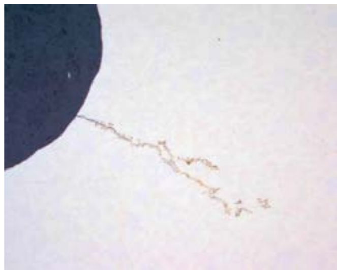
Pukotina koja polazi od dužine navoja, mikroskopski snimak
