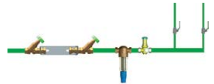
Kućni priključak za pitku vodu
