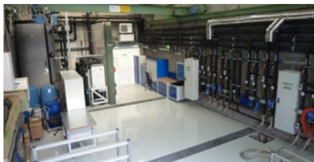
Versuchsaufbau AKM mit Regelkugelhähnen und Mischventilen von HERZ
