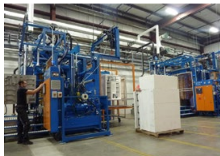
Produktion von Porozell-Schalungssteinen auf einer HIRSCH Formteilmaschine
