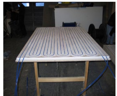
Die Matten für die Deckenkühlung werden je nach Bedarf in allen möglichen Dimensionen hergestellt
