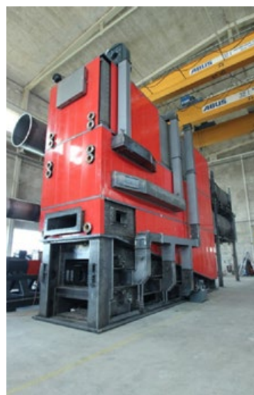
Die 9.000-Kilowatt-Dampfanlage für ein Sägewerk in Uruguay ist einer der größten Kessel, den BINDER je gebaut hat
