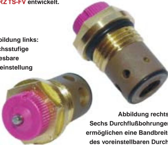
Abbildung rechts: Sechs Durchflußbohrungen ermöglichen eine Bandbreite des voreinstellbaren Durchflußwertes zwischen Kvmin 0,019 und Kvmax 0,300
