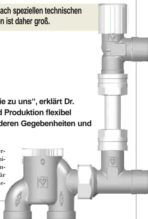
T-Stück und Radiatoranschluss 1/2". Rohrmittelabstand 40 mm mit Außengewinde G3/4 und Konus für HERZ-Klemmsatz für Weichstahl- Kupfer- und Kunststoffrohr. Anschlüsse G 3/4 nach DIN V 3338.
