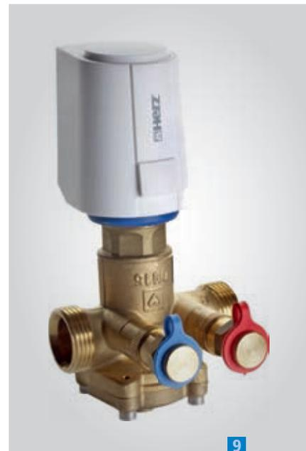
**9** Bei dem Kombiventil 4006 Smart von Herz Armaturen werden ein Regulierventil, ein Regelventil, ein Differenzdruckregler und ein Absperrventil miteinander kombiniert. (Foto: Herz Armaturen)
