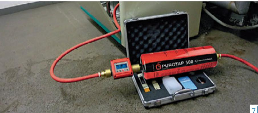
6| Umlaufentsalzung mit dem „PUROTAP Profi 25“, sowie Erstbefüllung mit bis zu 1.500 Liter/h möglich.
