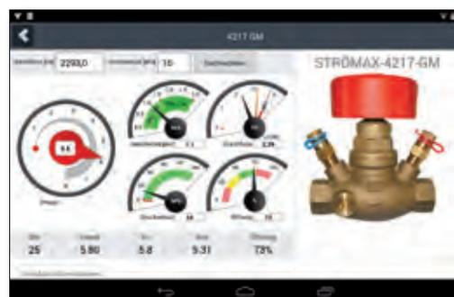
mal ausgelegt. In der Auswahl werden zusätzlich der berechnete minimale Druckabfall und die notwendige Voreinstellung angezeigt. Die Voreinstellung entspricht der Ventilöffnung. Detaillierte Informationen über das Ventil können mit einem Druck auf die Auswahl aufgerufen werden.
