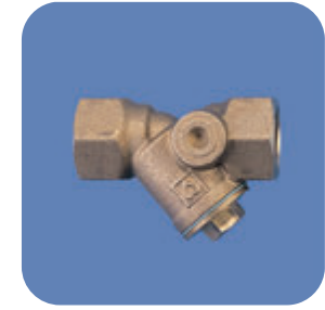
HERZ-hvatač nečistoća 4111 instalira se ispred HERZ-regulatora diferencijalnog tlaka (finoća mrežice 0,4 mm) kako bi se spriječilo oštećenje
