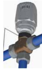
Ventilgehäuse aus Messing, Stahlspindel Niros, Dichtungen EPDM. Alle Gehäuse aus Messing unvernickelt, blank, mit blauer Schraubkappe, ohne Anschlüsse geliefert. Thermostatanschlussgewinde M 28 x 1,5 HERZ.
