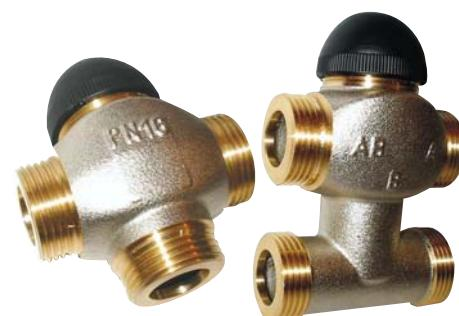
Ventil ravne izvedbe i troputni ventil PN 16, ventili jednako postotne karakteristike, su prilagođeni na kontinuirani pogon 7711. Spajanje je jednostavno, otpada biranje smjera zatvaranja. Potreban je samo jedan pogonski tip u izvedbi "bez napajanja otvoren", jer sve izvedbe imaju isti smjer zatvaranja. Stopostotno zatvaranje postignuto je, također kod miješajućeg voda. Ventil se može koristiti kao mješajući, razdjelni ili kao preklopni ventil.
