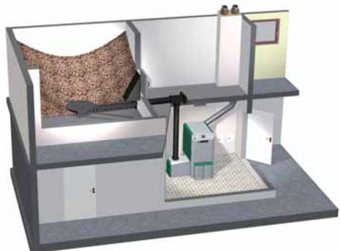
Prostorija skladišta i kotlarnica na različitim nivoima. Horizontalno pražnjenje sa pužem.
