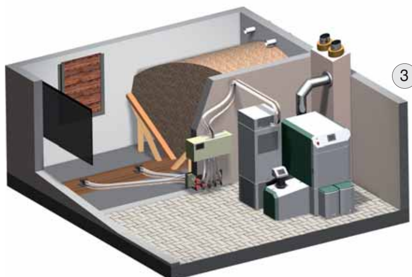
4-tačke usisni sistem -sistem se lako instalira, prilagodljiv u različitim situacijama i skladišnim prostorima je univerzalno rešenje.
