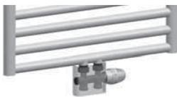
Anschlussvariante Design Rundrohrheizkörper, chrom, mit mittigem Anschluss, Anschlussmuffen Rp 1/2, 50 mm Mittelmaß, mit Anschlussgarnitur Eckform HERZ-TS 3000 1 **3694 91**, Abdeckung chrom für HERZ-3000 1 **0100 41**, Thermostat chrom DE LUXE 1 **9200 41**, geeignet für Zweirohranlagen, Rohranschluss G 3/4 A mit Innenkonus, Kunststoffrohranschlüsse **6098** für PE-X, PB und Aluminiumverbundrohre, Klemmset für Stahl- und Kupferrohre **6276**.
