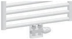
Anschlussvariante Design Rundrohrheizkörper, weiß RAL 9010, mit mittigem Anschluss, Anschlussmuffen Rp 1/2, 50 mm Mittelmaß, mit Anschlussgarnitur Durchgangsform HERZ-TS 3000 1 **3692 91**, Abdeckung weiß, RAL 9010 für HERZ-3000 1 **0100 21**, Thermostat Mini 1 **9200 30**, Abdeckhülse weiß, 1 **9596 44** geeignet für Zweirohranlagen, Rohranschluss G 3/4 A mit Innenkonus, Kunststoffrohranschlüsse **6098** für PE-X, PB und Aluminiumverbundrohre, Klemmset für Stahl- und Kupferrohre **6276**.
