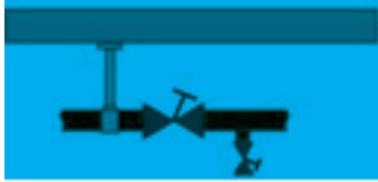
ÜBLICHE MONTAGE: Kugelhahn und Füll/Entleerventil
