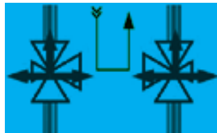
Oben geöffnet Unten geschlossen Mögliche Flussrichtung: links/rechts
