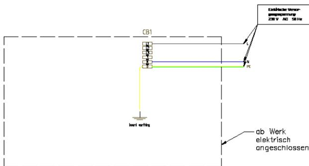
Mitgelieferte elektrische Komponenten (Antrieb für Zonenventil) sind gemäß elektrischem Anschlussplan zu verdrahten. Es muss die Spannungsversorgung 230 V/AC im Klemmenkasten und die jeweiligen Raumthermostate, gemäß Herstellervorgaben elektrisch angeschlossen werden. Der Klemmenkasten befindet sich im rechts oberen Bereich der WÜS Pressburg.
