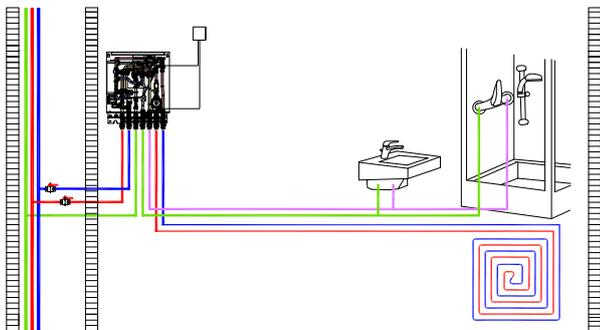
Die Übergabestation wird parallel an das Netz der Fernwärme angeschlossen. Wenn möglich sollte die Übergabestation noch vor dem ersten Verbraucher angeschlossen werden.
