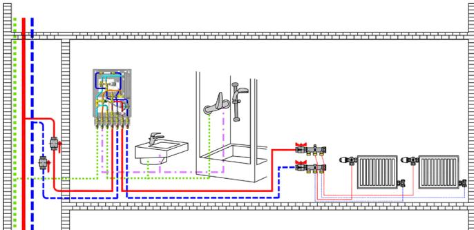
Die Übergabestation wird parallel an das Netz der Fernwärme angeschlossen. Wenn möglich sollte die Übergabestation noch vor dem ersten Verbraucher angeschlossen werden.
