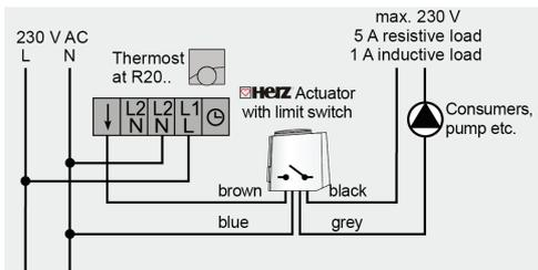
Für die Installation einer 230 V-Anlage empfehlen wir folgende Leitungen:
