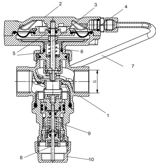
Die Verwendung von Ethylen- und Propylenglykol ist im Mischungsverhältnis 25 - 50 Vol.- [%] zulässig. Im Hanf enthaltene Ammoniak schädigt Messingventilgehäuse. EPDM Dichtungen werden durch Mineralöle bzw. mineralöhlhaltige Schmierstoffe aufgequollen und führen somit zum Ausfall der EPDM-Dichtungen. Für Frost- und Korrosionsschutzmittel auf der Basis von Ethylen- und Propylenglykol sind die entsprechenden Angaben den Unterlagen des Herstellers zu entnehmen.
