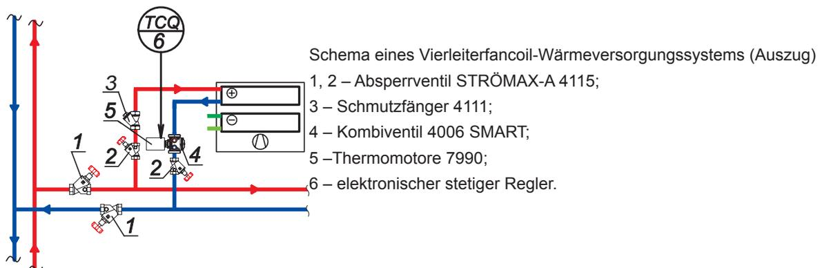
Kombiventile im Einsatz mit einer hydraulischen Weiche.
