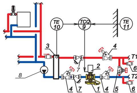
1 - Kombiventil 4006; 2 - Thermomotore 7990; 3 - hydraulische Weiche; 4 - Absperrventil STRÖMAX-A 4115; 5 - Strangregulierventil STRÖMAX-GM 4217; 6 - Kesselfüll- und Entleerungshahn THERMOFLEX 4119; 7 - Schmutzfänger 4111; 8 - Umwälzpumpe; 9 - elektronischer stetiger Regler; 10 - Temperaturfühler des Heizungswassers; 11 - Außentemperaturfühler.
