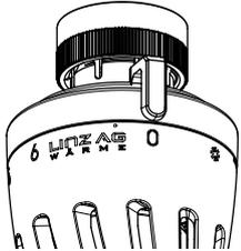
Bei Stellung „0“ wird das Thermostatventil abgesperrt und die Frostsicherung außer Kraft gesetzt.
