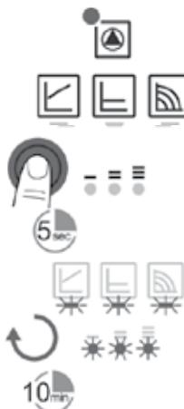
Насос пытается выполнить автоматический перезапуск при блокировке.
