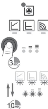
Заполните и удалите воздух из системы надлежащим образом. Если из полости ротора насоса воздух не удаляется автоматически:
