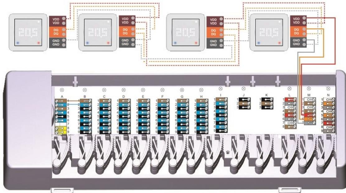
Das 1-Wire-System ist mit 3 Adern auszuführen (5 VDC, DQ, GND). Die Gesamtkabellänge kann so bis zu 100 m betragen. Es ist ein geeignetes Twisted Pair Kabel zu verwenden und auf ausreichenden Leiterquerschnitt zu achten, z.B. LIYCY 2 x 2 x 0,75 mm<sup>2</sup>, um unzulässigen Spannungsabfall an den HERZ clever&smart LEDcontroller unter  $U_{\min} = 4,5$  VDC zu vermeiden.
