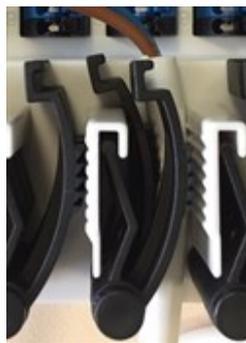
Die Zugentlastungen sind für flexible Leitungen mit einem Kabelmanteldurchmesser von 5 mm bis 8 mm geeignet, wobei primär die untere Zugentlastung (wie abgebildet) verwendet werden soll. Die Leitungen sind auf festen Sitz zu prüfen. Massive sowie dickere und dünnere Leitungen sind auf jeden Fall fest zu verlegen und installationsseitig zu fixieren.
