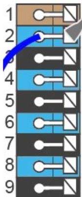
Massive Leitungen oder Kabel mit speziellen Aderendhülsen können einfach in die Klemmen eingedrückt werden. Bei anderen Leitungen ist die Kelle zuvor mit einem Schraubenzieher wie abgebildet **vollständig aufzudrücken**.
