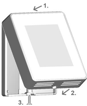
Das Bedienteil wie im Bild illustriert auf dem Gehäuseunterteil aufsetzen und mit der mitgelieferten Schraube fixieren.
