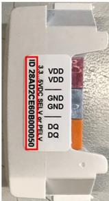
Jeder HERZ clever&smart Raumsensor schmal It hat eine eindeutige 16-stellige 1-Wire ID. Diese ID wird zur Sensor-Raum-Zuordnung im HERZ clever&smart Raumcontroller benötigt. Die ID finden Sie im Inneren des Sensors auf dem Typenschild sowie auf dem mitgelieferten Aufkleber. Wir empfehlen, den Aufkleber in die Tabelle der HERZ clever&smart Regelbox Bedienungsanleitung oder in den HERZ clever&smart Regelbox Klemmplanaufkleber zu kleben, um die spätere Konfiguration des Systems zu vereinfachen.
