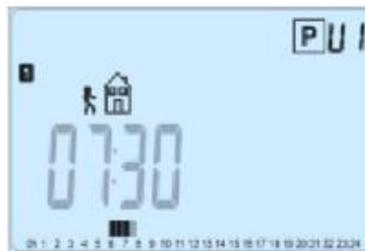
Mittels der Tasten **(-)** oder **(+)** die Uhrzeit der Rückkehr einstellen.
