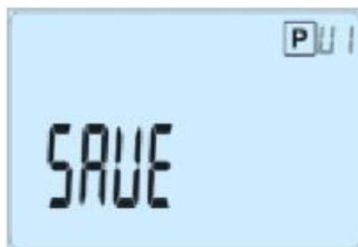
Um das Programm zu speichern, die Taste **(OK)** betätigen. Es erfolgt die Rückkehr in den Betriebsmodus **AUTO**; das Thermostat arbeitet nach dem eingestellten Programm. Um Änderungen im Benutzerprogramm zu löschen, die Taste Zurück (
