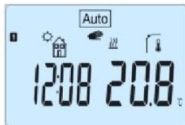
**Bemerkung:** Die Zeit wird von der Zentraleinheit gesteuert, somit sind sämtliche Einrichtungen mit der selben Zeit synchronisiert.
