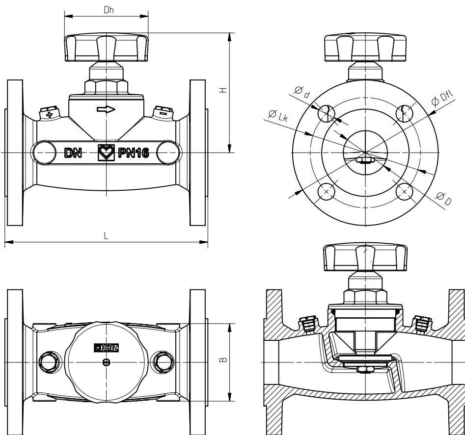
Габаритные размеры в мм
