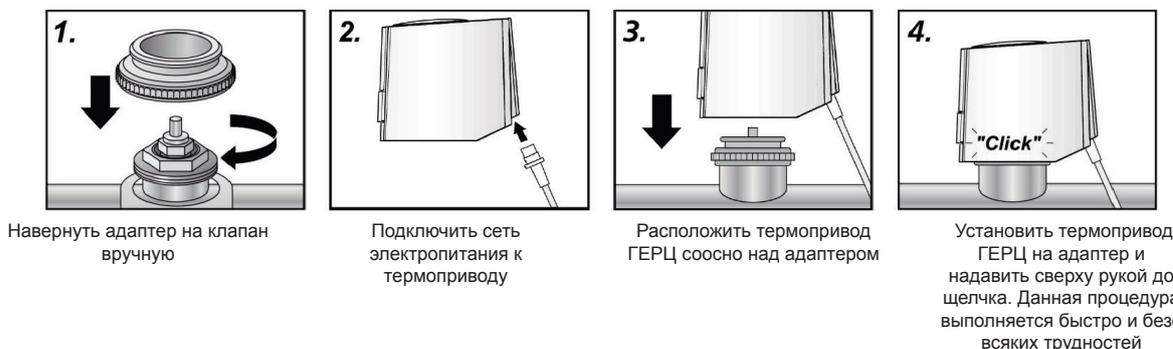
Для демонтажа необходимо провести процедуру в обратном порядке. Для разблокировки необходимо нажать на соответствующую кнопку, на фронтальной стороне привода.
