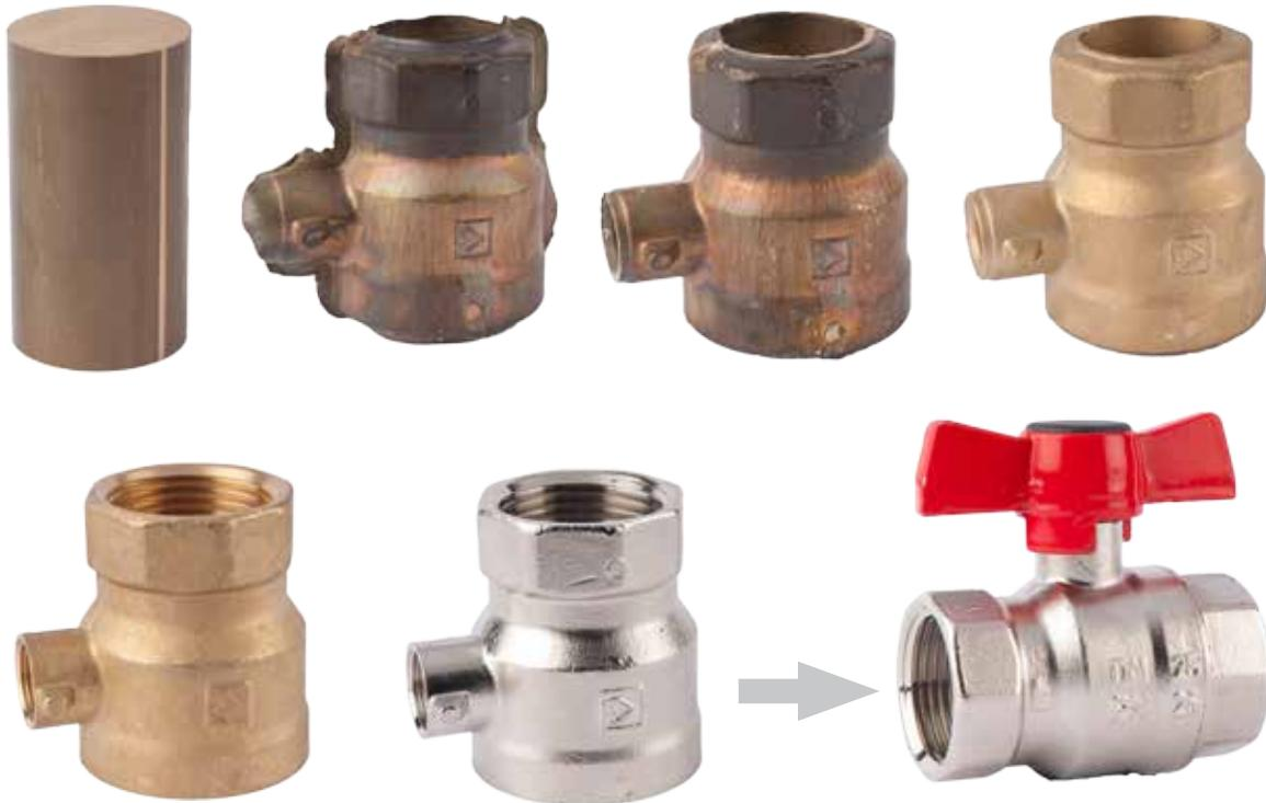
U Herz-u obradu vršimo na specijalnim alatnim strojevima i preciznim CNC mašinama. Odljevci se mehanički obrađuju do stupnja, da su prikladni za neposrednu montažu. Na večini strojeva je proces automatiziran s robotskom manipulacijom koja omogućuje stabilnost
