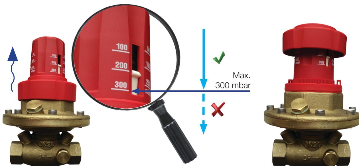
Der Differenzdruck-Sollwert wird durch Anheben der roten Abdeck-Sicherungskappe und Verdrehen der Einstellkappe durchgeführt. Der einzustellende Sollwert kann an der Skala abgelesen werden. Danach wird die Abdeck-Sicherungskappe wieder in Richtung Gehäuse geschoben. Damit wird der eingestellte Sollwert fixiert. Bei den Führungsstiften der Sicherungs-Abdeckkappe kann auch eine Plombierung angebracht werden.
