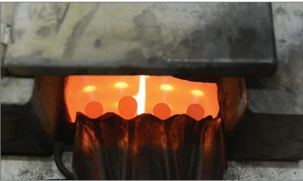
Je nach Komplexität und Größe des Schmiedeteils werden Schmiedepressen verwendet, die Schließkräfte zwischen 120 und 360 Tonnen aufbringen. Der gesamte Prozess ist automatisiert und wird in jeder Phase überwacht und kontrolliert.
