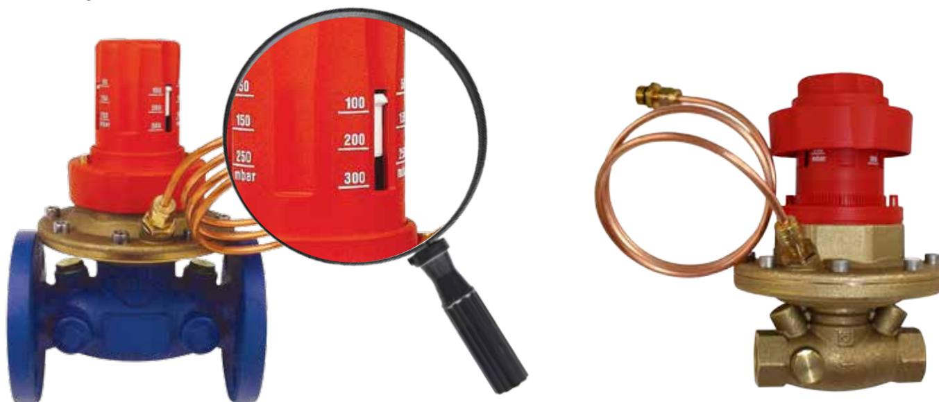
Zur Einstellung des Differenzdruck-Sollwerts hebt man die rote Abdeck-Sicherungskappe und dreht die Einstellkappe bis zur gewünschten Anzeige. Der einzustellende Sollwert kann an der Skala abgelesen werden. Danach die Abdeck-Sicherungskappe wieder in Richtung Gehäuse schieben - der eingestellte Sollwert wird dadurch fixiert. Bei den Führungsstiften der Sicherungs-Abdeckkappe kann auch eine Plombierung angebracht werden.
