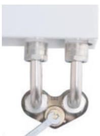
9. Die Montage ist abgeschlossen, der korrekte Anschluss von Vor- und Rücklauf am Heizkörper wird einfach durch Erwärmung überprüft. Im Bedarfsfall wird durch einfaches Umschalten die Durchlaufrichtung getauscht!
