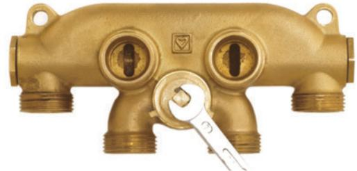
Der korrekte Anschluss von Vor- und Rücklauf am Heizkörper kann während der Inbetriebnahme des Heizsystems an dessen Erwärmung überprüft werden. Wurden die Anschlüsse vertauscht, wird einfach mittels Schlüssel umgestellt.
