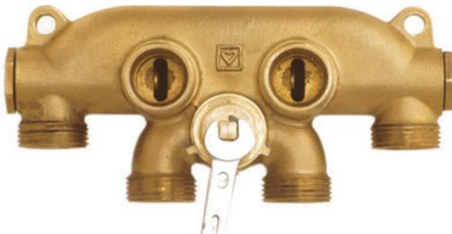
Zum Absperrn des Heizkörpers wird die Verstellspindel in die Mittelposition gestellt. Der Anschlag ist senkrecht zum Fußboden bzw. im rechten Winkel zur horizontalen Verteiler-Längsachse ausgerichtet.
