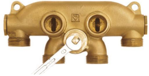
Ein Wechsel zwischen Vor- und Rücklauf wird durch Links- bzw. Rechtsdrehen der Spindel durchgeführt. Ausgehend von der Absperrposition wird der Schlüssel bis zum Anschlag im oder gegen den Uhrzeigersinn verdreht.
