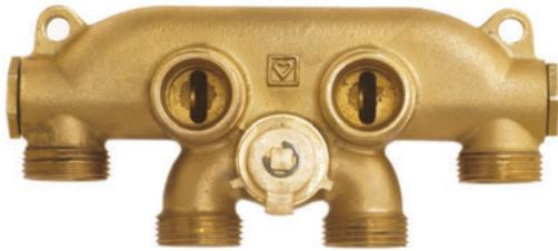
Der HERZ-SWITCHFIX besteht aus zwei Durchlaufkanälen, die durch je zwei HERZ-Klemmsets mit den Vor- und Rücklaufleitungen eines Heizkreislaufes verbunden werden. Der Heizkörper wird mit zwei vernickelten HERZ-Anschlussbögen (1 6333 00) und zwei HERZ-Klemmsets (nach Wahl) mit dem Umschaltverteiler verbunden, die Anschlüsse dafür befinden sich zwischen den Durchlaufkanälen.
