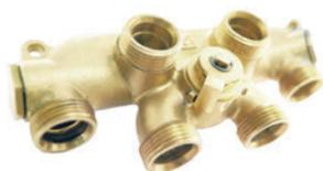
HERZ-Umschaltverteiler für Zweirohranlagen SWITCHFIX 1 3030 01, zum Umschalten und Absperrn für strömungsrichtigen und kreuzungsfreien Anschluss des Heizkörpers an das Rohrnetz, G 3/4
