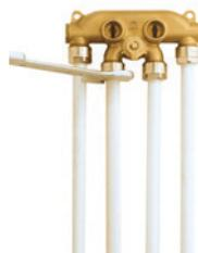
3. Die Verrohrung erfolgt von Verteiler zu Verteiler. Dabei wird zur Vermeidung von Rohrüberkreuzungen wahlweise der Vorlauf an den inneren oder äußeren Anschlüssen des 2-Rohr-Verteilers mittels HERZ-Klemmsets angeschlossen.
