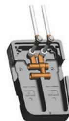
HERZ-Sockelleistenverteiler 1 3012 22 für kreuzungsfreien Radiatoranschluss für die Unterputzmontage, bei Verlegung der Rohrleitungen in der Wand, nicht absperrbar. Anschlüsse M 22 x 1,5 und G 3/4 mit Konus, waagrecht
