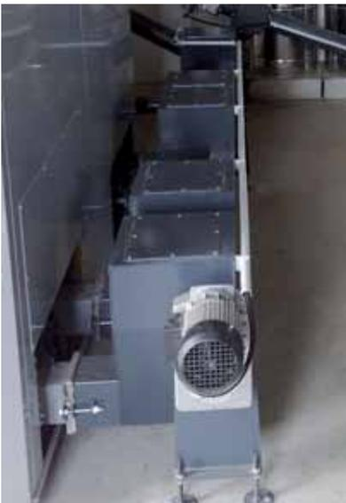
Zentrales Aschenaustragsystem mittels Schnecke: Der Vorteil des Betreibers liegt in den geringeren Reinigungsintervallen sowie der komfortablen Beseitigung der Asche.
