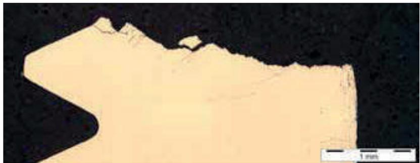
Bruch infolge von Spannungsrisskorrosion durch den Gewindebereich einer Messingarmatur (erster tragender Gewindegang); die Spannungsrisskorrosion wurde an der Innenoberfläche (rechts) ausgelöst.
