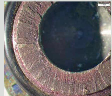
Bruchfläche einer infolge von Spannungsrissskorrosion gebrochenen Messingarmatur. Die Spannungsrissskorrosion wurde infolge von erhöhten Montagekräften eingeleitet.
