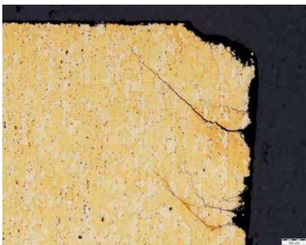
Spannungsrisskorrosion in Messing; Rissbildung an der Oberfläche und Rissausbreitung unter Bildung von Rissverästelungen
