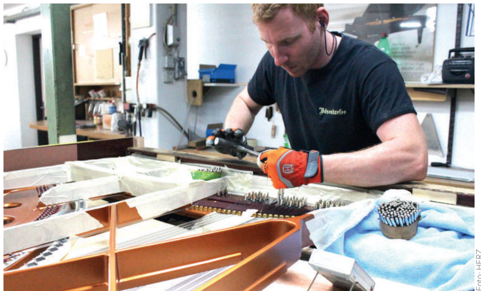
Bösendorfer Klavierherstellung - Saiten werden manuell angespannt.
