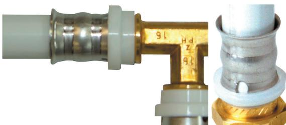
Kontrolle der Verpressung: Am Umfang der Presshülse erkennt man zwei gleichlaufende, ringförmige Verpressungen. Dazwischen ist eine Aufwölbung erkennbar.
