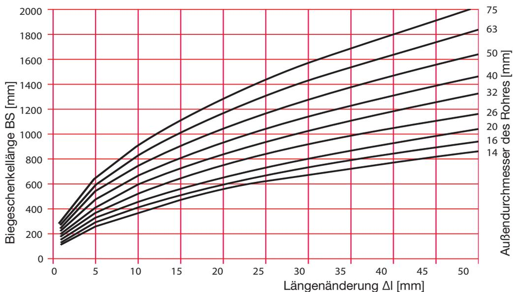
Frei verlegte Rohre benötigen durch die Formstabilität keine unterstützenden Hilfsmittel wie Tragschalen, Stützrohre oder Ähnliches. Die Unterstützungsabstände der Rohre können der nachstehenden Tabelle entnommen werden. Rohrschellen aus Kunststoff oder Metall sollten eine Einlage aus Gummi oder aus weichem Material haben um eine Beschädigung des Rohres zu vermeiden und die Schallübertragung ausschließen.
