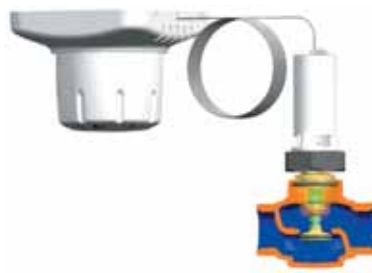
Sobna temp. iznad podešene vrijednosti, ventil otvoren
