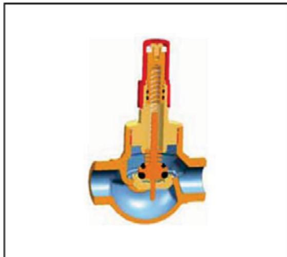
Sl. 8-11 Prestrujni ventil (Herz art. 4004) i presjek ventila
