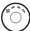
Navojna kapa služi za rukovanje za vreme prekoda rada instalacija (ispiranje cevovoda). Skidanjem navojne kape i navrtanjem HERZ-termostatske glave moguće je postaviti termostatski pogon bez pražnjenja sistema.
