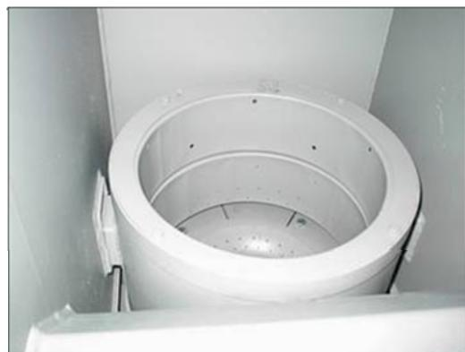
Gorionik se sastoji iz tri dela. Prvi deo se nalazi na dnu slike (gore, desno) i izgleda kao tanjur sa otvorima i proreza po obimu. To je primarni prsten. Na njemu se odvija sagorevanje. Kroz otvore dolazi primarni vazduh. Prorez po obimu služe da bi se rasteretio deo od toplotnog naprezanja i da bi prilikom čišćenja (vibraciono) došlo do propadanja pepela.
